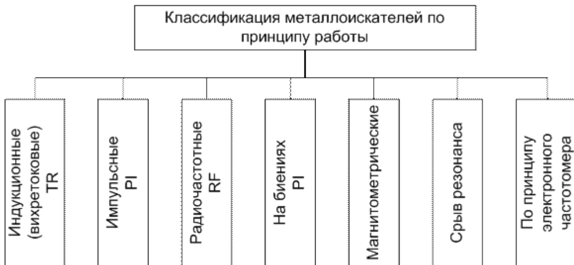
Рисунок 2 - Классификация металлоискателей по принципу действия
