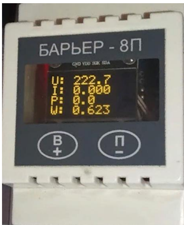
Рисунок 2 – WEB-монитор в корпусе от реле напряжения «Барьер»
