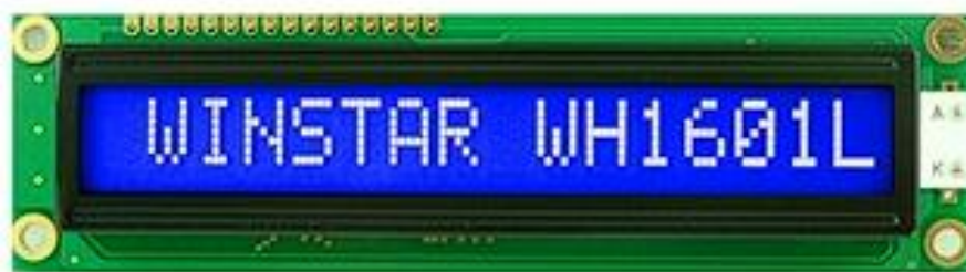
Рисунок 2 – Внешний вид жидкокристаллического индикатора WH1601L
