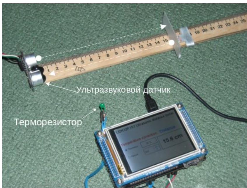
Рисунок 3 - Ультразвуковой дальномер на основе платы UDK32-F107V
