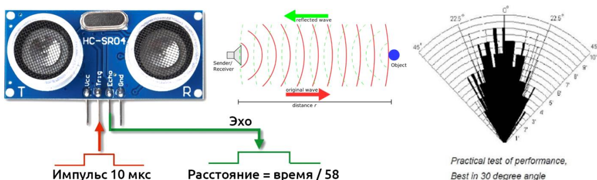
Рисунок 1 - Принцип работы датчика
