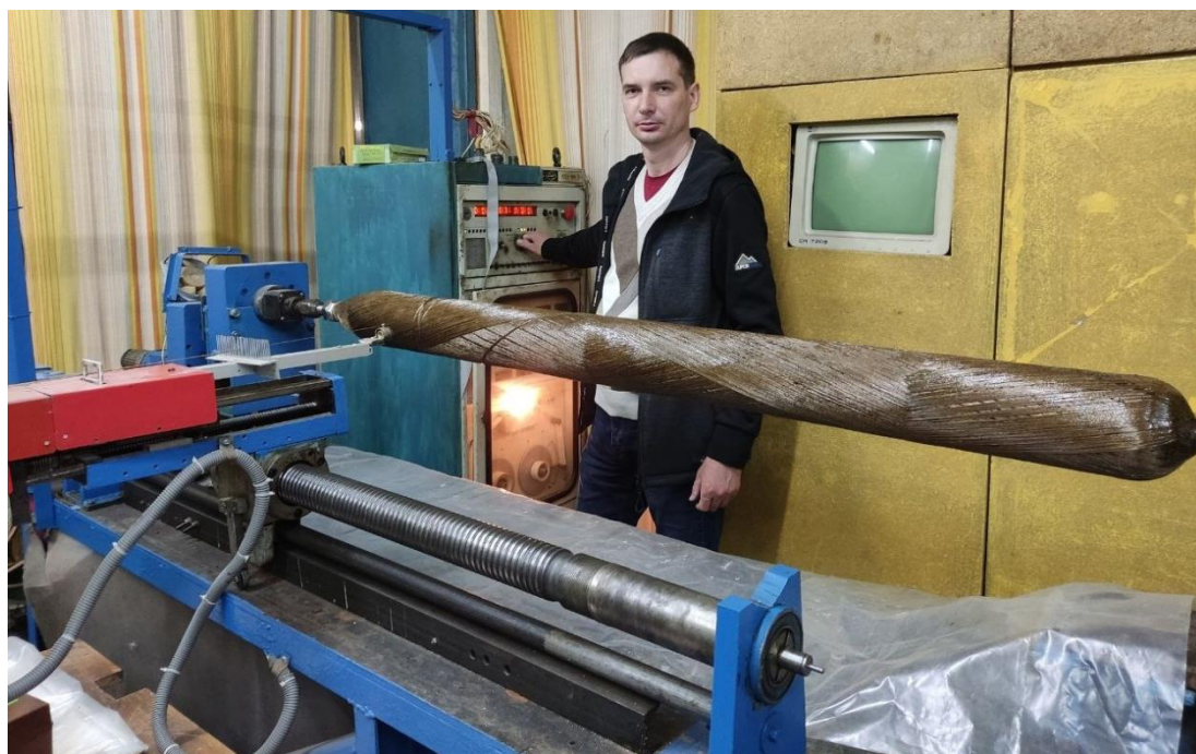
Рисунок 2 – Процесс намотки ствольного шахтного огнетушителя
