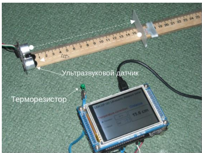
Рис. 1. Ультразвуковой дальномер на основе платы UDK32-F107V
