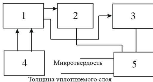
Рис.1. Блок-схема прибора измерения микротвердости и толщины виброупрочняемого слоя металла.
